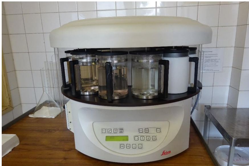
Obr. 20 Tkáňový procesor („autotechnikon“) TP 1020 Automatic Tissue Processor (Leica Biosystems, Germany)
