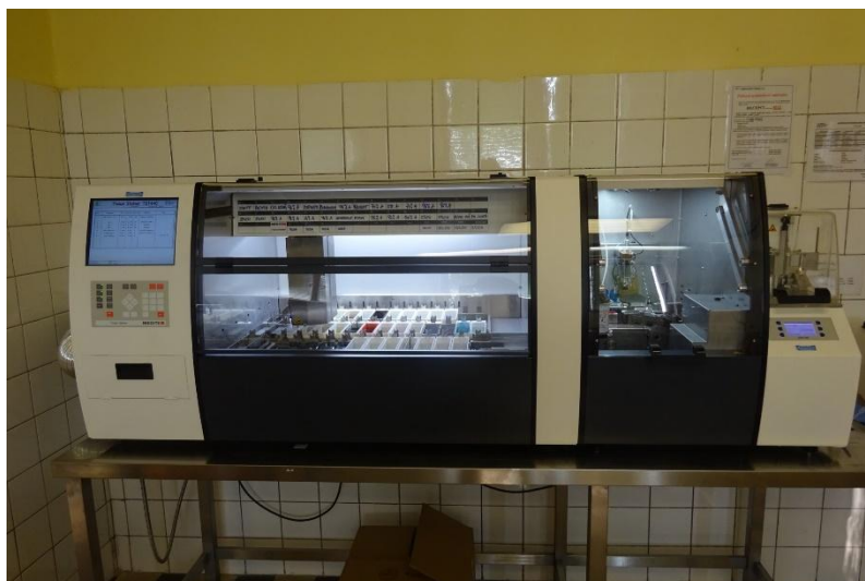
Obr. 24 Barvicí a montovací automat TST 44.200C / ACS 720 (Medite GmbH, Germany)
