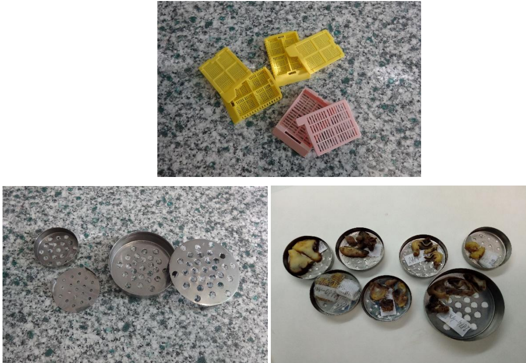
Obr. 19 Kazety pro přikrájené vzorky vkládané do autotechnikonu
