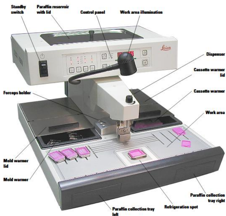
Obr. 9 Zalévací parafinová linka
