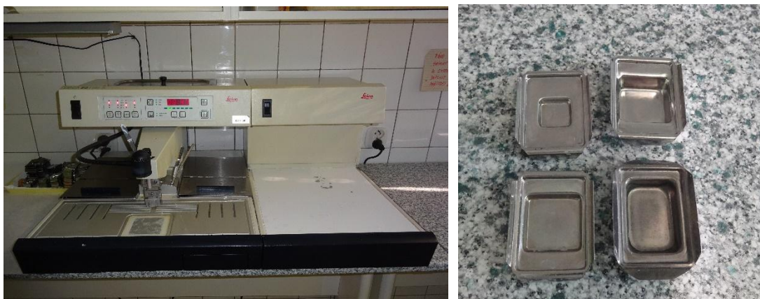
Obr. 21 Zalévací parafinová linka Leica EG 1150 H (Leica Biosystems, Germany) a formy na zalévání vzorků
