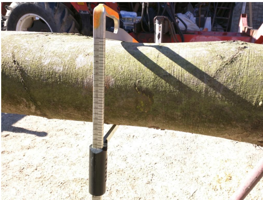
Obrázek 16 Použití průměrky při měření průměru
