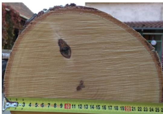
Obrázek 22 Detail skryté vady dřeva, která mohla být příčinou vyšší hodnoty příkonu
