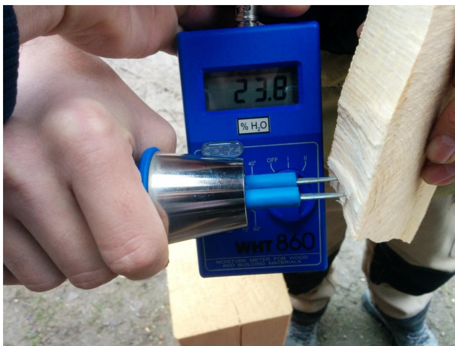
Obrázek 21 Měření vlhkosti dřeva vlhkoměrem Elbez
