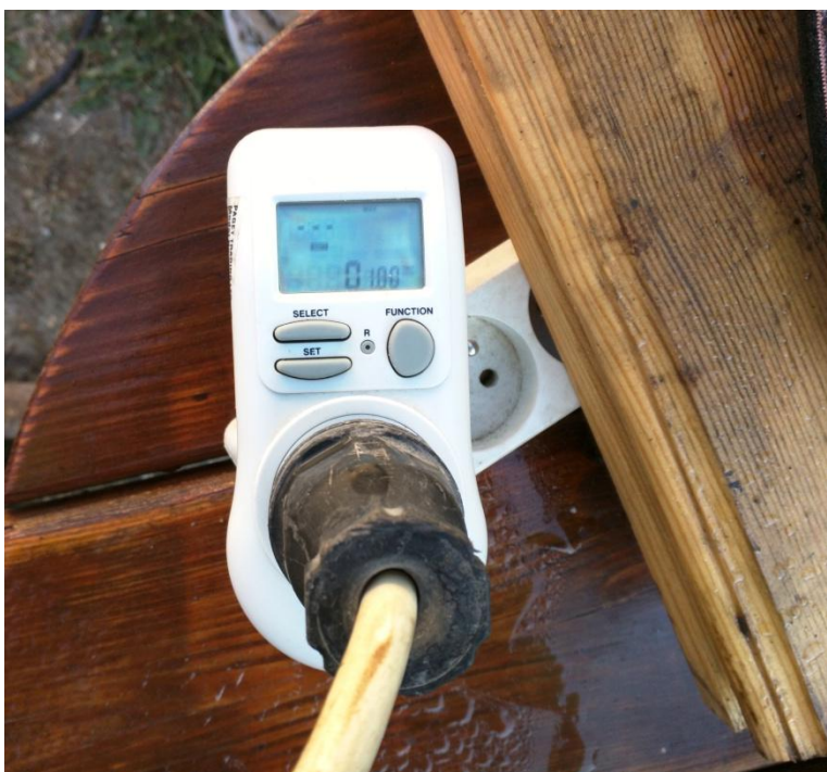
Obrázek 19 Digitální měřič spotřeby energie použitý při měření příkonu
