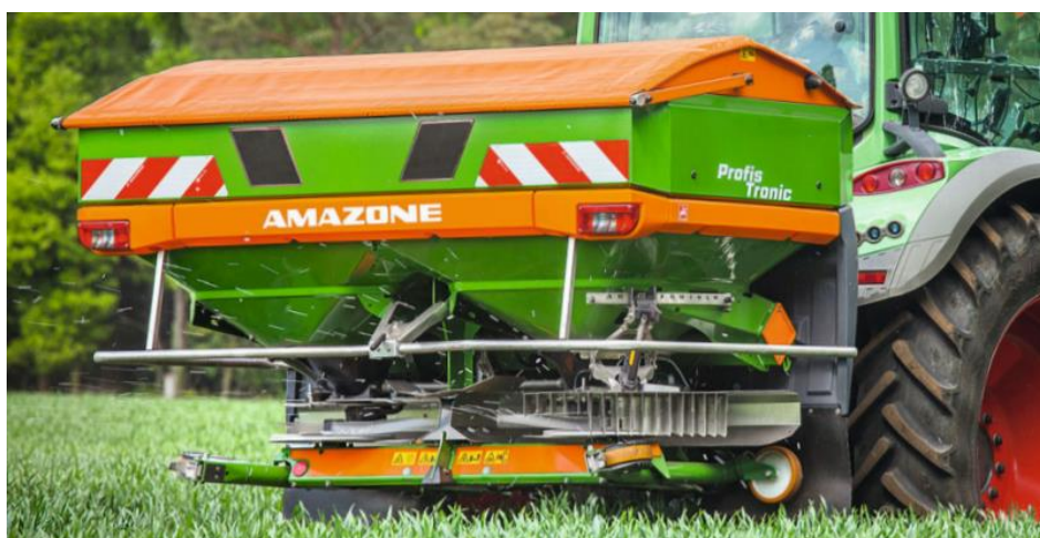
Obrázek 14: Vodorovný rozmetací kotouč [22]
