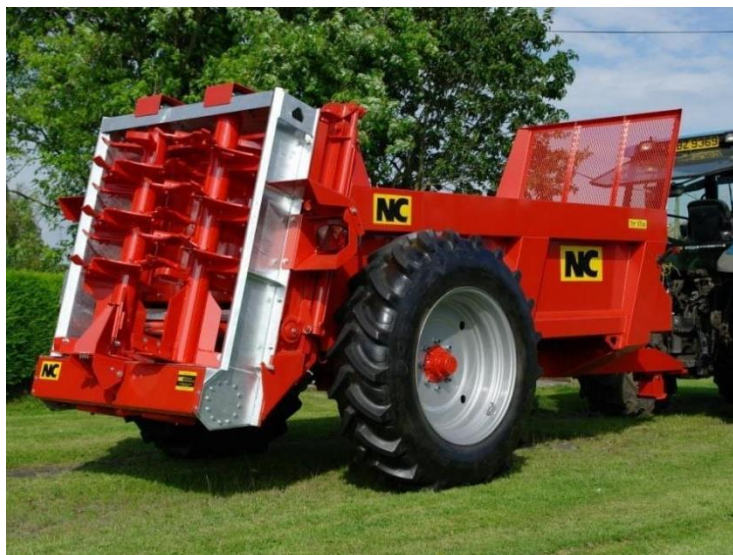
Obrázek 5: Bubnové rozmetací ústrojí s vertikálním uspořádáním válců [14]
