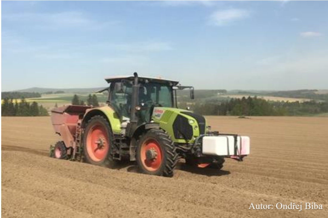
Obrázek č. 15 Claas Arion 550 se sazečem AVR s aplikátorem kapalných hnojiv při práci (Agrodam Hořepník s.r.o.) („Foto: Ondřej Bíba“)
