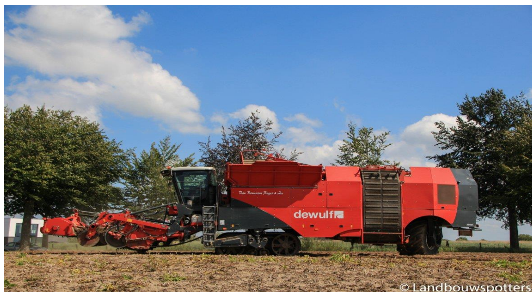
Obrázek č. 45 Dewulf Kvatro, Kombinace pásového a kolového podvozku se zadním říditelným kolem [54]
