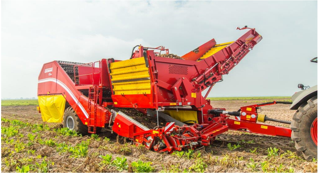
Obrázek č. 42 Sklízeč se zásobníkem Grimme SE 290 Evo [51]
