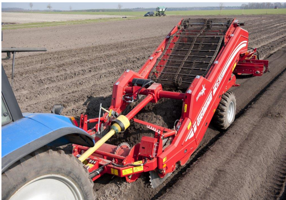
Obrázek č. 11 Separátor Grimme s hydraulicky ovládanou rohoží na hoře [18]
