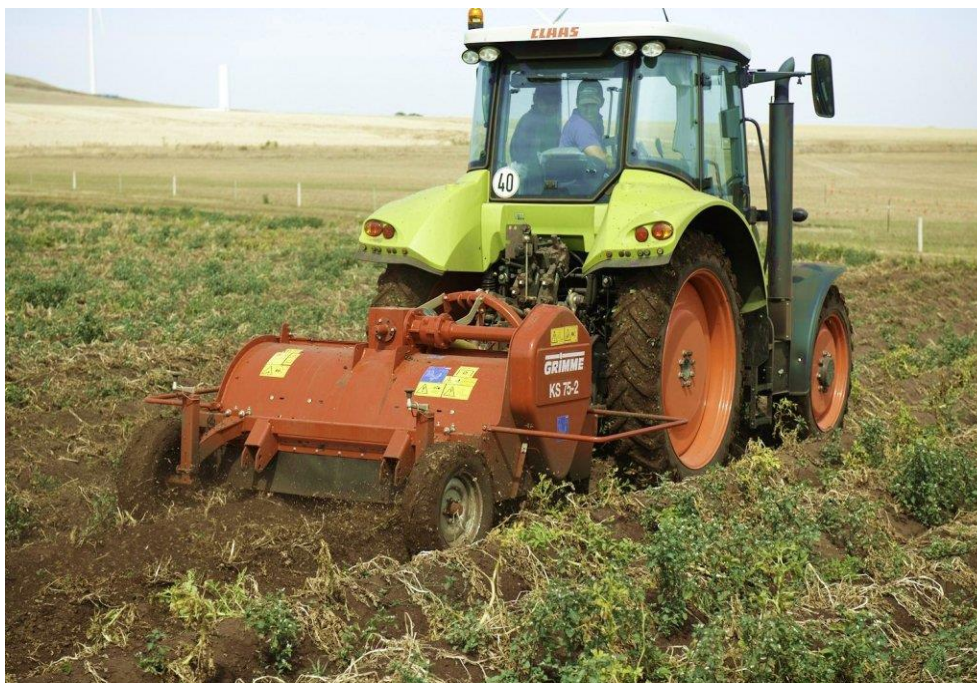
Obrázek č. 36 Kladívkový drtič natě Grimme KS 75-2 při práci [41]
