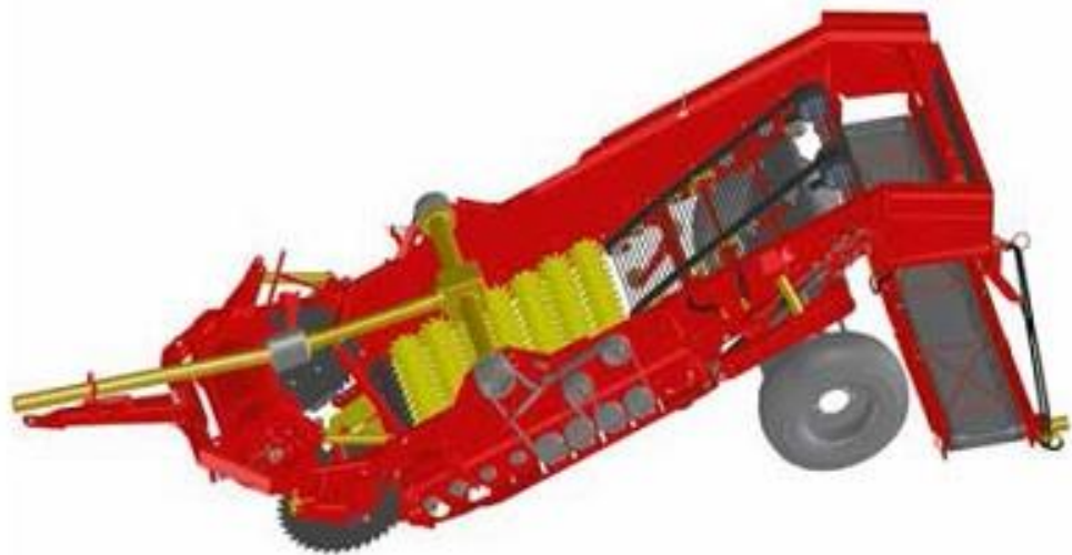
Obrázek č. 10 Kombinovaný separátor Grimme CS 150 Combi-star [16]
