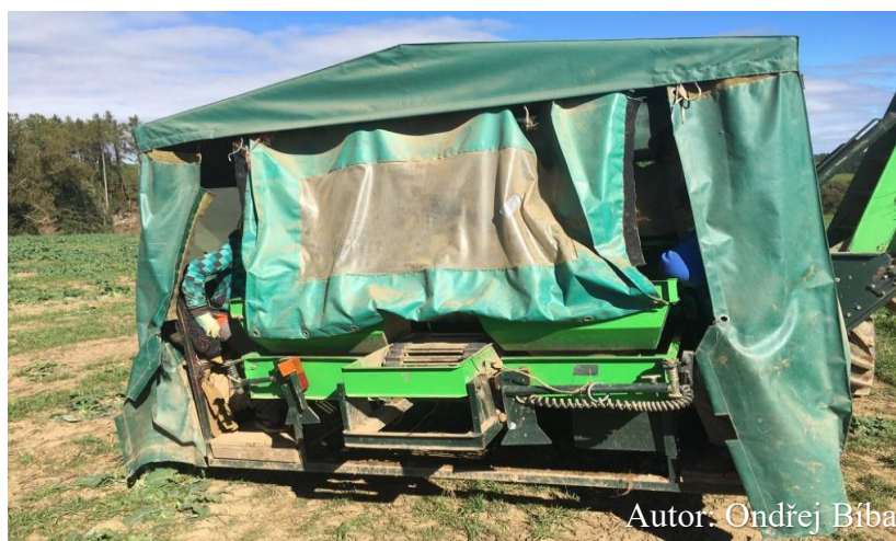
Obrázek č. 57 Přebírací stůl s přístřeškem sklízeč bez zásobníku („Foto: Ondřej Bíba“)
