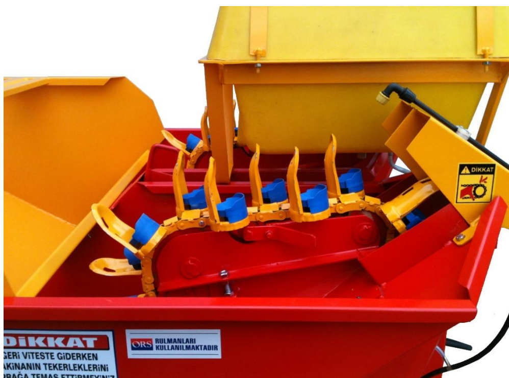
Obrázek č. 23 Elevátorový mechanismus s dvoufázovým náběrem [31]
