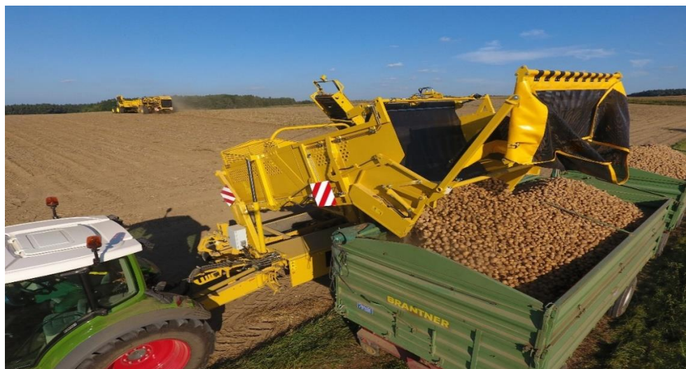
Obrázek č. 59 Ropa Keiler 2 při vyprazdňování zásobníku se zvednutým tlumičem nárazu [61]
