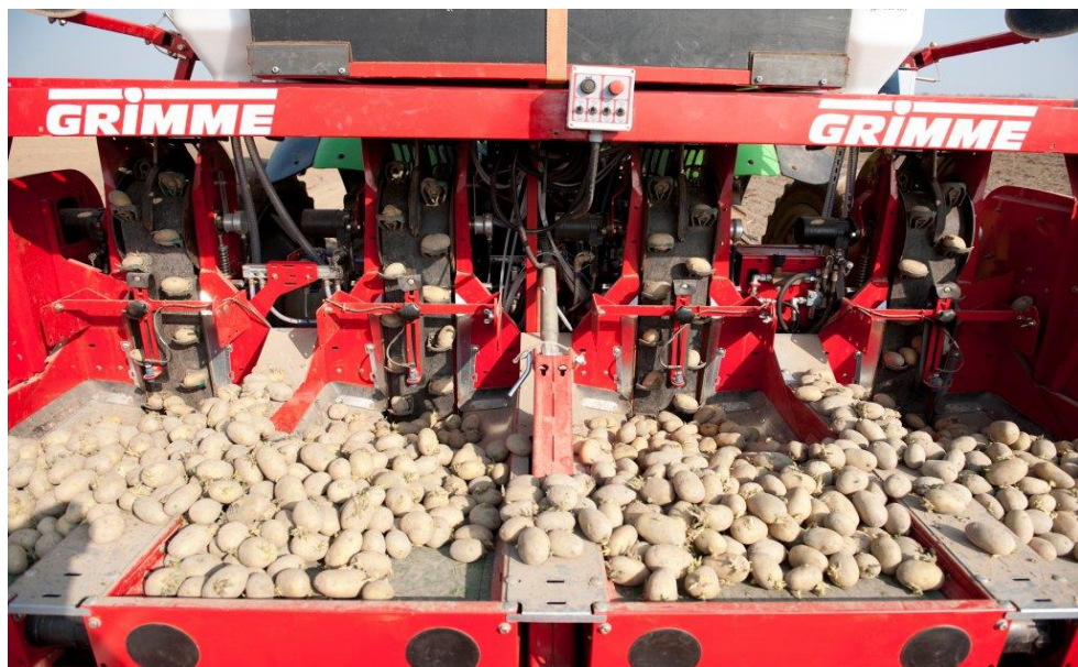
Obrázek č. 19 Grimme GL 420 Poloautomatický systém vyprazdňování přepravek se sadbou na dopravník vedoucí k miskám [29]
