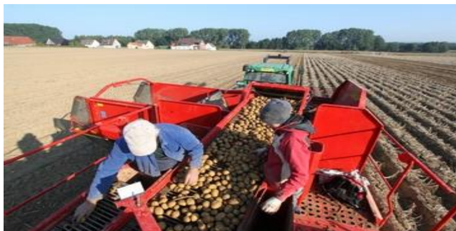
Obrázek č. 56 Obsluha u přebíracího stolu sklízeče se zásobníkem [59]
