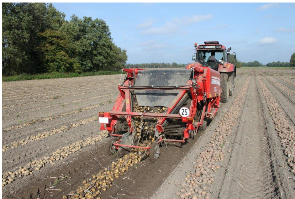
Obrázek č. 40 Vyorávač Grimme WR 200 s vyoráním do řádku [48]
