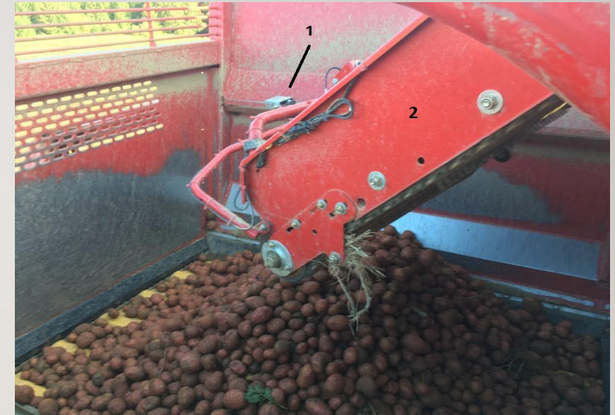
1) Čidlo zajišťující vyhodnocování 2) Polohovatelný dopravník
