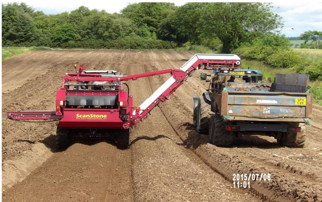
Obrázek č. 12 Odkládací dopravník vlevo a překládací dopravník vpravo firma Scanstone [19]
