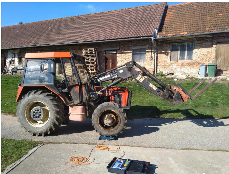
Obrázek 15: Zetor 7340 Turbo s čelním nakladačem umístěný ve výšce 100 cm nad povrchem
