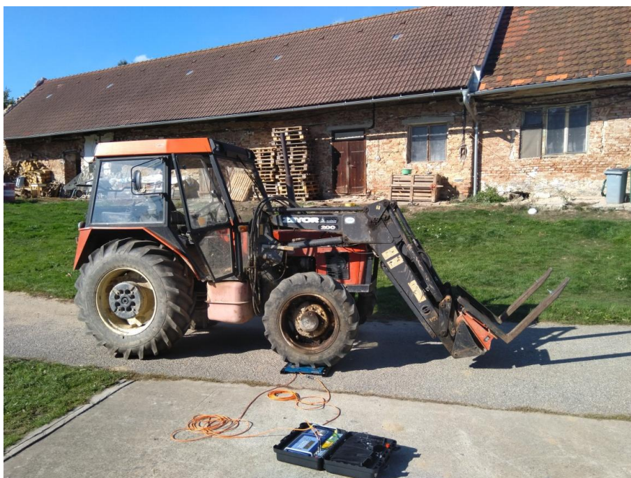
Obrázek 14: Zetor 7340 Turbo s čelním nakladačem umístěný ve výšce 15 cm nad povrchem
