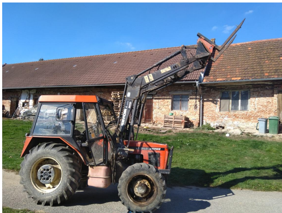
Obrázek 16: Zetor 7340 Turbo s čelním nakladačem umístěný v maximální zdvižené poloze
