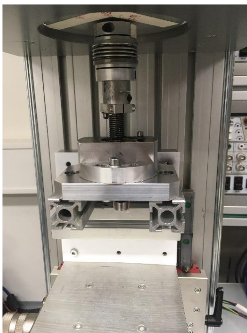
Obrázek 17 - Měřicí stojan s upevněným vzorkem (přípravek s pružinami) (Obsluha stroje pro měření funkčních zkoušek GPA-S, 2013)
