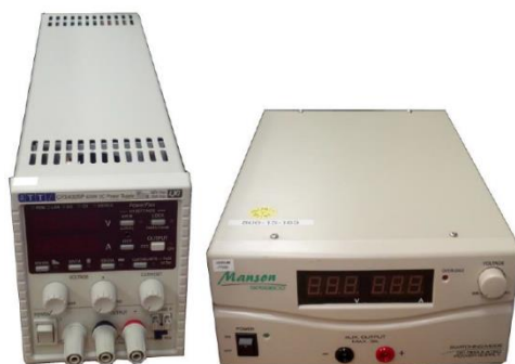
Obrázek 19 - Napájecí zdroje proudu (Obsluha stroje pro měření funkčních zkoušek GPA-S, 2013)
