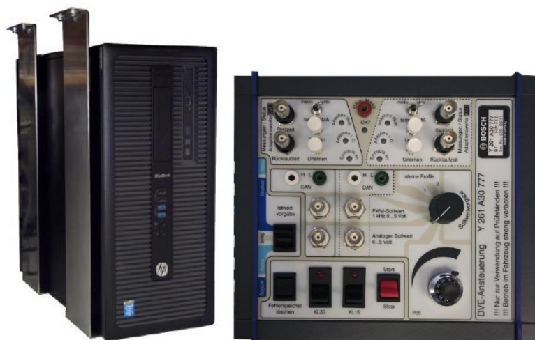
Obrázek 20 - Řídící počítač a řídicí jednotka MED17 (vpravo) (Obsluha stroje pro měření funkčních zkoušek GPA-S, 2013)
