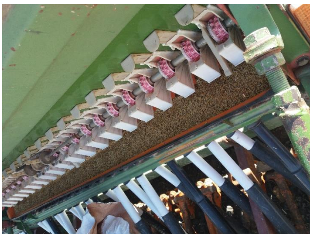
Obr. č. 2 Detail secího mechanismu (secí válečky s výsevní skříní), (AMAZONE RP-AD 402)
