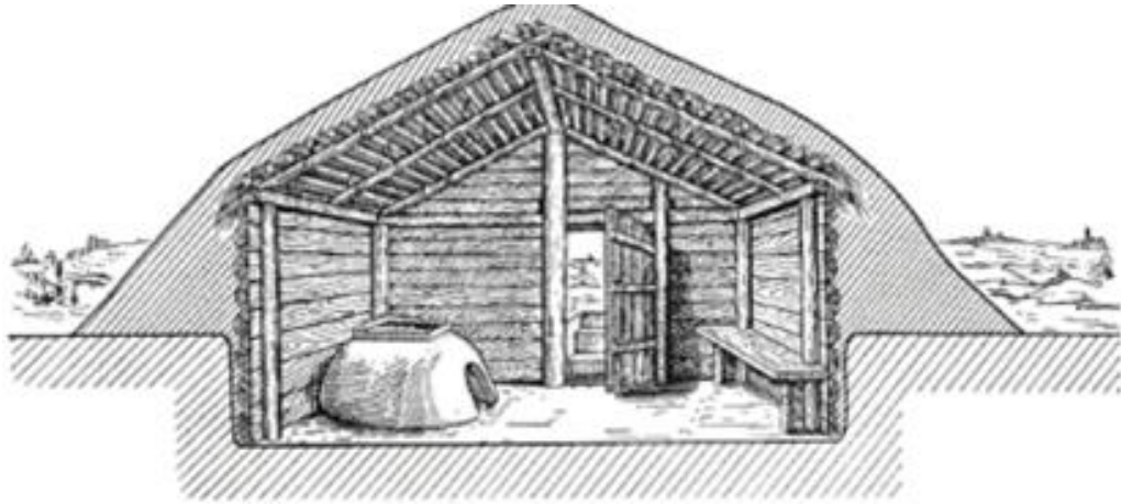
Obrázek 3-Zahloubené obydlí s roubenou konstrukcí a hliněnou pecí
