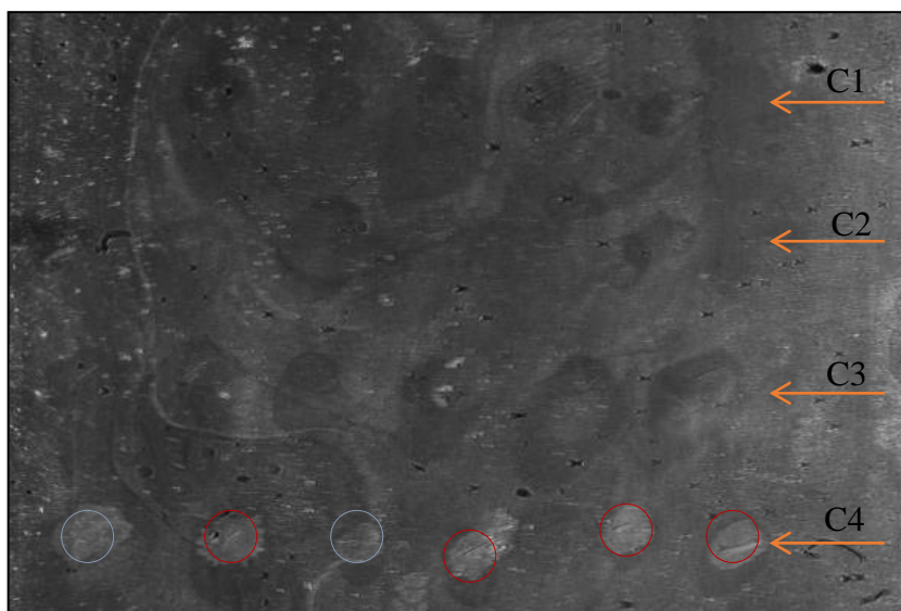
Obr. 7 Ukázka povrchu biočipu po ukotvení séra s protilátkou nebo negativní kontroly o různé koncentraci (c1 – c4). Jednotlivé koncentrace protilátky (červené body) a pre-séra (modré body) jsou na čip umísťovány v řadách. Měření pak probíhá na vybraných bodech.
