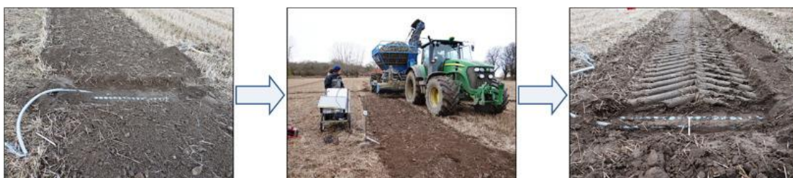
Obrázek 2.6: Postup při polním měření distribuce vertikálního zatížení půdního povrchu v závislosti na druhu podvozku (Lamandé, M. et al., 2018)
