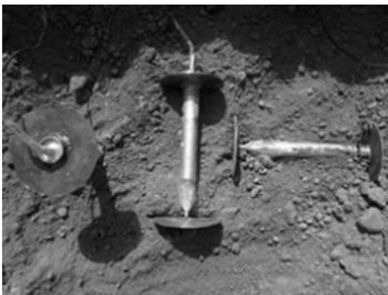
Obrázek 2.9: Umístění půdních snímačů napětí ve směru podélném, horizontálním a vertikálním (Shahgholi, G. et al.;2015)
