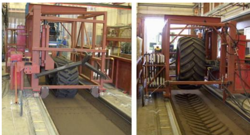
Obrázek 2.4: Zkušební laboratorní přístroj simulující přejezdy zemědělské techniky (Ansorge, D. et al., 2007)
