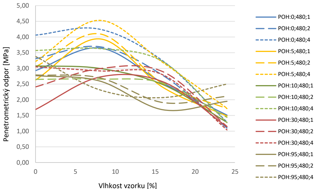
Obrázek 5.15: Závislost penetrometrického odporu v 10 cm hloubky na vlhkosti vzorku s různým obsahem POH po zatížení tlakem 480 kPa v cyklu 1; 2; 4.
