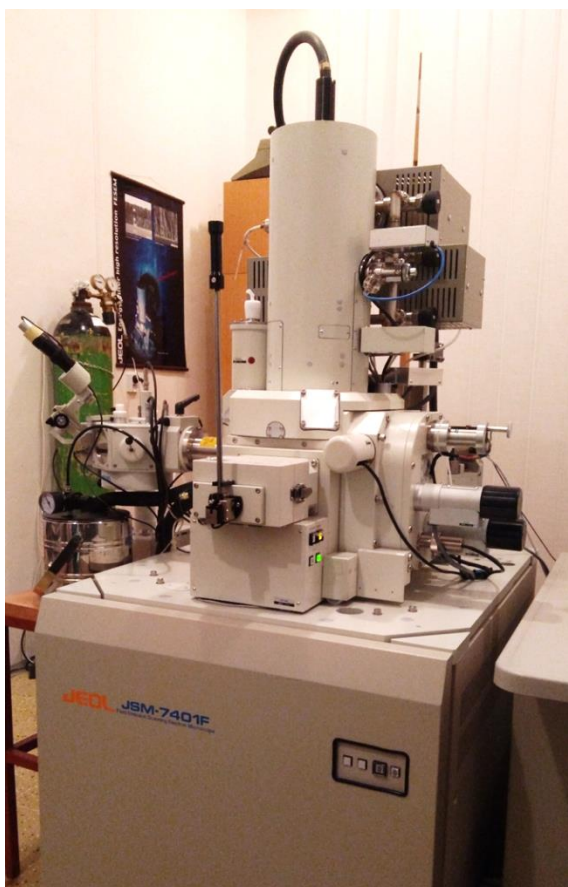
Obrázek č. 9: JOEL JMS-7401F Skenovací elektronový mikroskop v Laboratoři elektronové mikroskopie Biologického centra Akademie věd České republiky.
