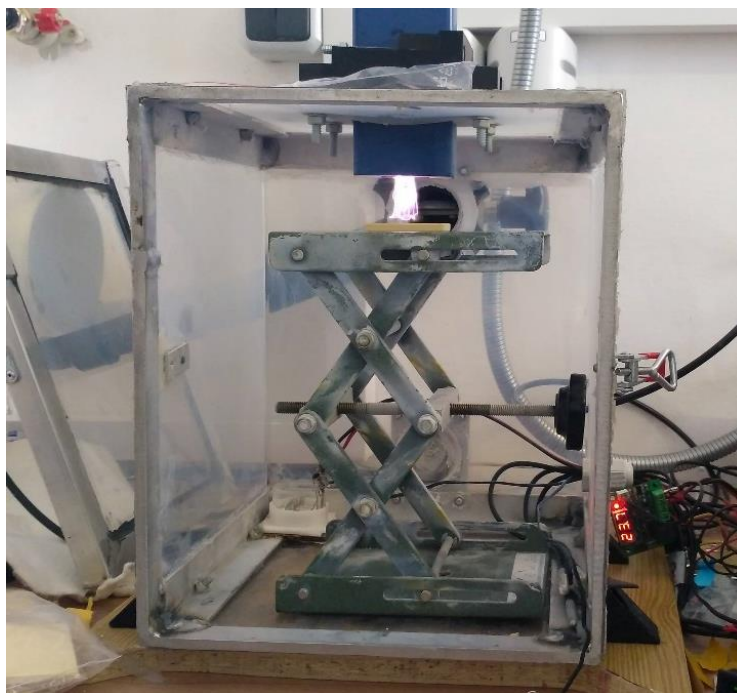
Obrázek č. 18: Uložení substrátu a plazmové trysky vně komory
