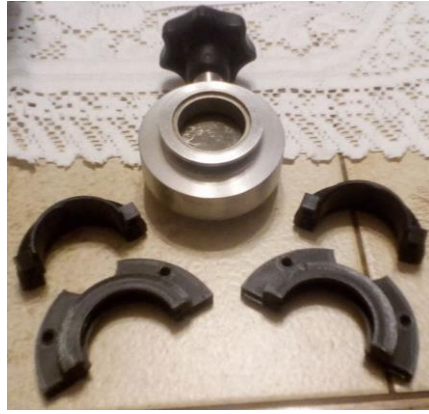
Obrázek č. 14: Regulační ventil s uchycením a redukcí na potrubí odsávání
