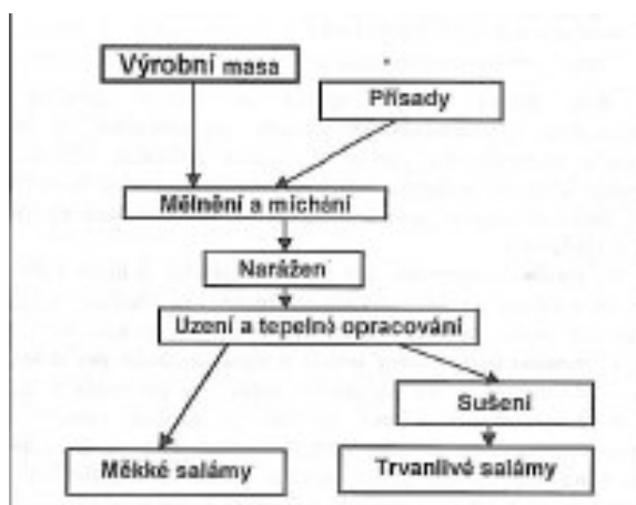
obr. 14 – Schéma výroby salámů
