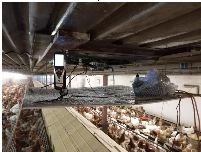
Obrázek 17 - Umístění měřicích přístrojů v blízkosti ventilátoru, zdroj: autor
