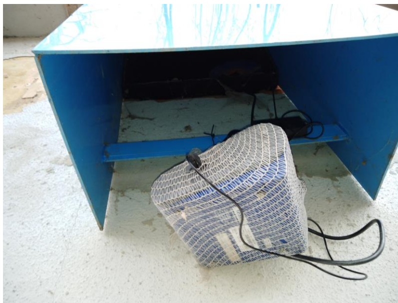
Obrázek 16 - Umístění měřicího přístroje DUSTTRAK II v přívodní klapce, zdroj: autor
