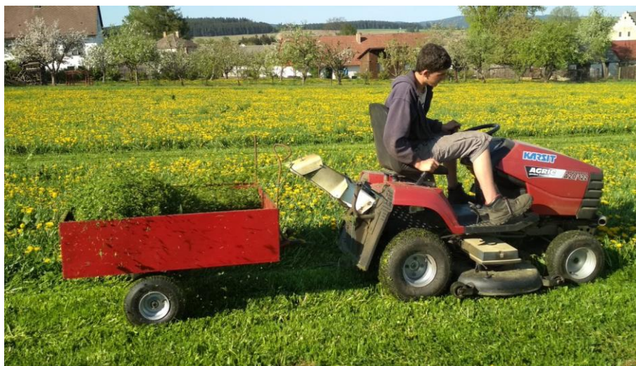
Obrázek 21 – Náhled na prodloužení výhozového tunelu a vozík, zdroj: autor
