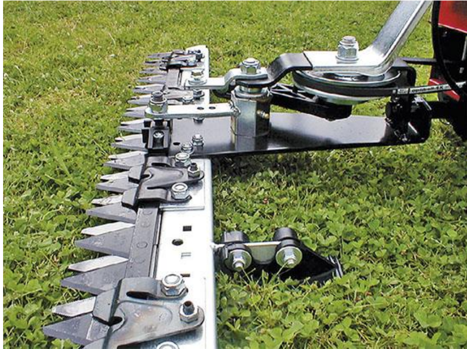
Obrázek 8 – Jednoduchý bezprstový adaptér připojený pomocí klínového řemenu ke stavebnicovému stroji, zdroj: http://www.chatar-chalupar.cz/wp-content/uploads/2015/11/li%C5%A1tov%C3%A9-2.jpg („staženo dne: 22. 1. 2019“)
