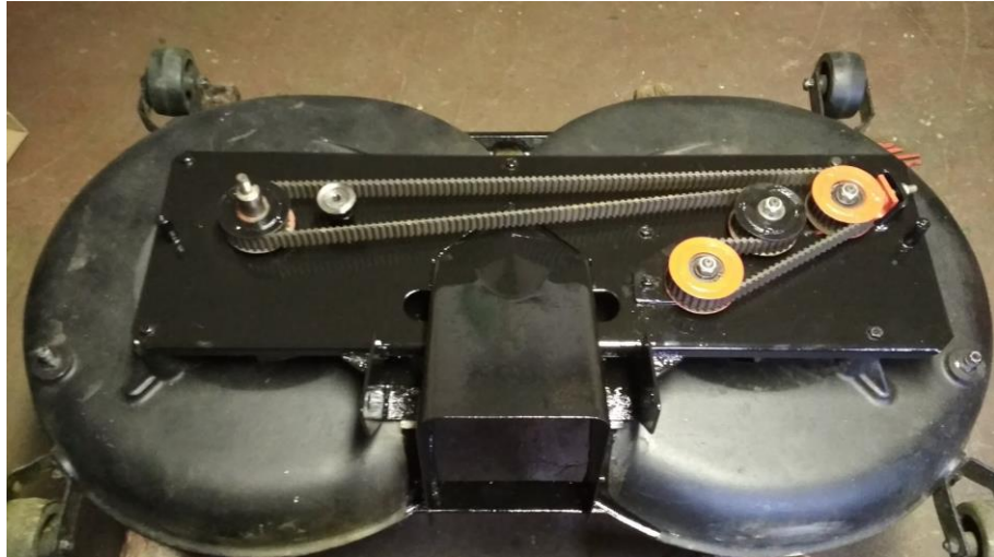
Obrázek 15 – Pohled na pohon pomocí oboustranného ozubeného řemenu, zdroj: autor
