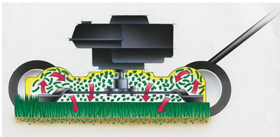
Obrázek 13 – Mulčování rotačním nožem s vertikální osou rotace, zdroj: https://www.garland.cz/tipy/jak-vybrat-sekacku/ („staženo dne: 30. 1. 2019“)
