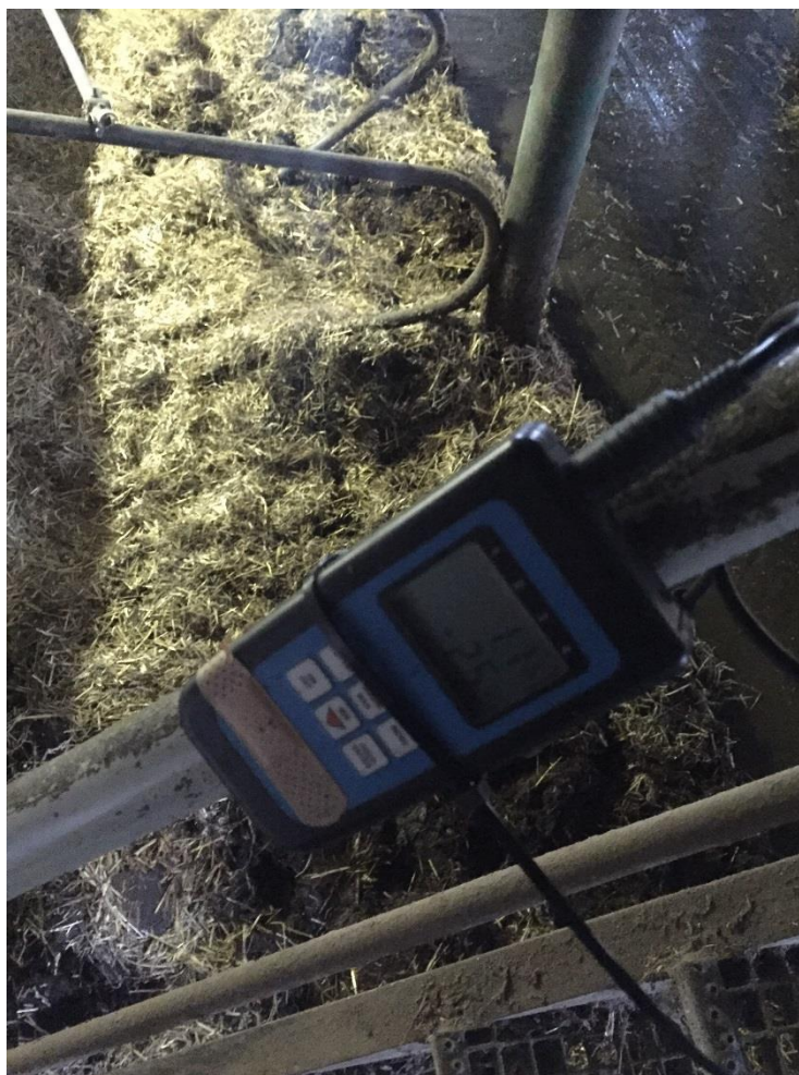
Obrázek č. 14 - Umístění měřicího přístroje COMMETER D4141
