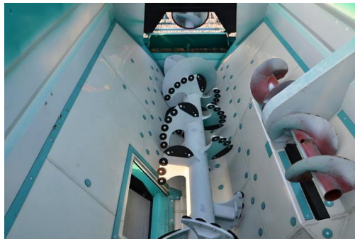
Obrázek č. 7 – Míchací zařízení s horizontálně uloženými šneky, zdroj:
