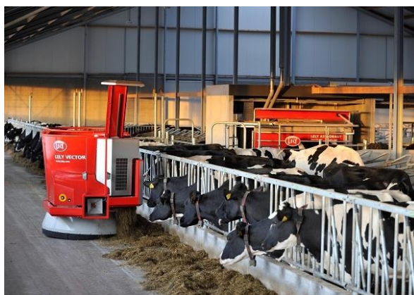
Obrázek č. 11 – Krmný robot Lely Vector, zdroj:
