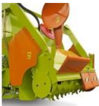
Obrázek č. 2 – Nakládací zařízení s rotační frézou, zdroj:
