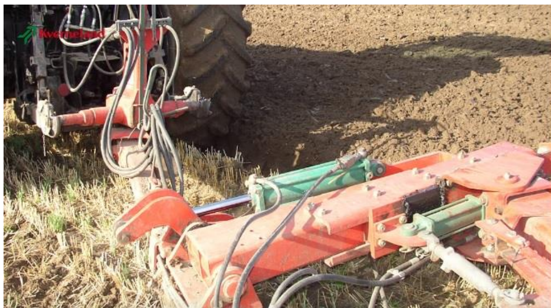
Obrázek 15 – Třibodový závěs a otočný mechanismus
