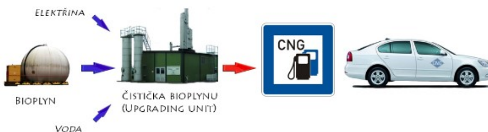
Obrázek č. 2 schéma úpravy bioplynu na CNG a využití v dopravě
