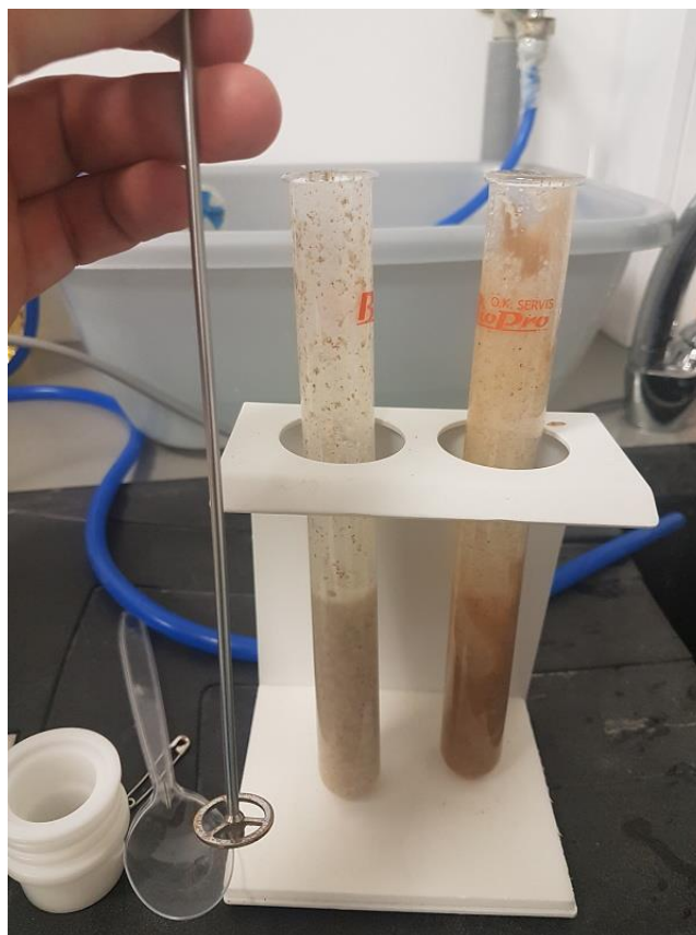
Příloha č. 10 – Stanovení čísla poklesu, zkumavka vlevo před vložením do vodní lázně, zkumavka vpravo po vyndání z vodní lázně.
