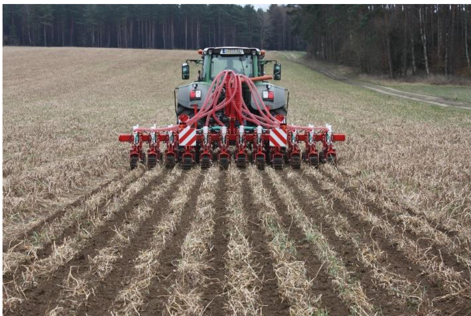
Obrázek č. 5: Zpracování pásů metodou Strip Tillage
