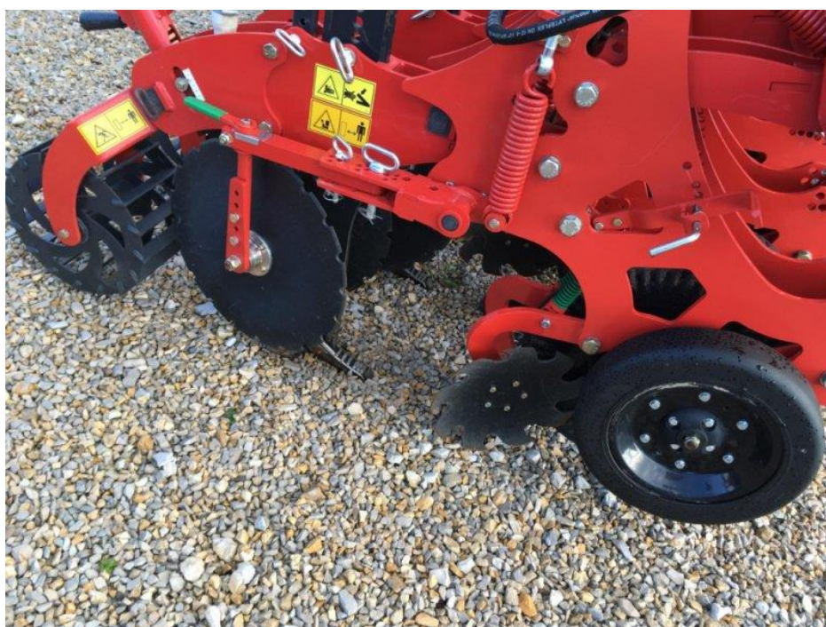
Obrázek č. 15: Uspořádání pracovní sekce Kverneland Kultistrip
