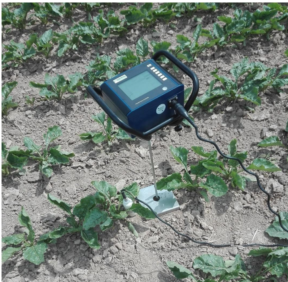
Obrázek č. 25: Přístroj na měření utužení půdy Penetrologer (autor)
