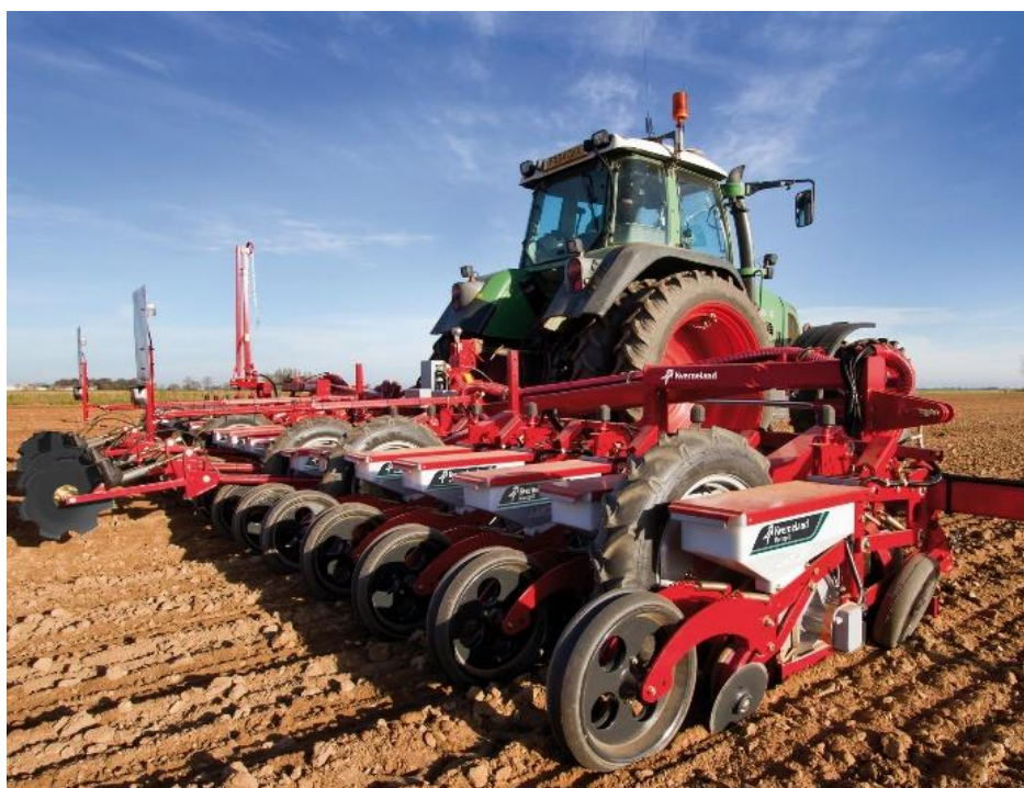
Obrázek č. 4: Secí stroj Kverneland Monopill pro setí do mulče
