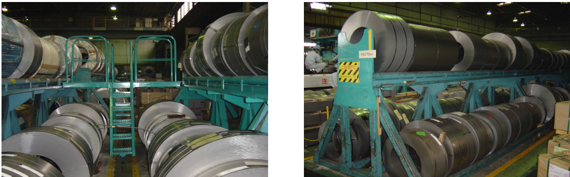
Obr. 11: Návrh nového způsobu skladování coilů
