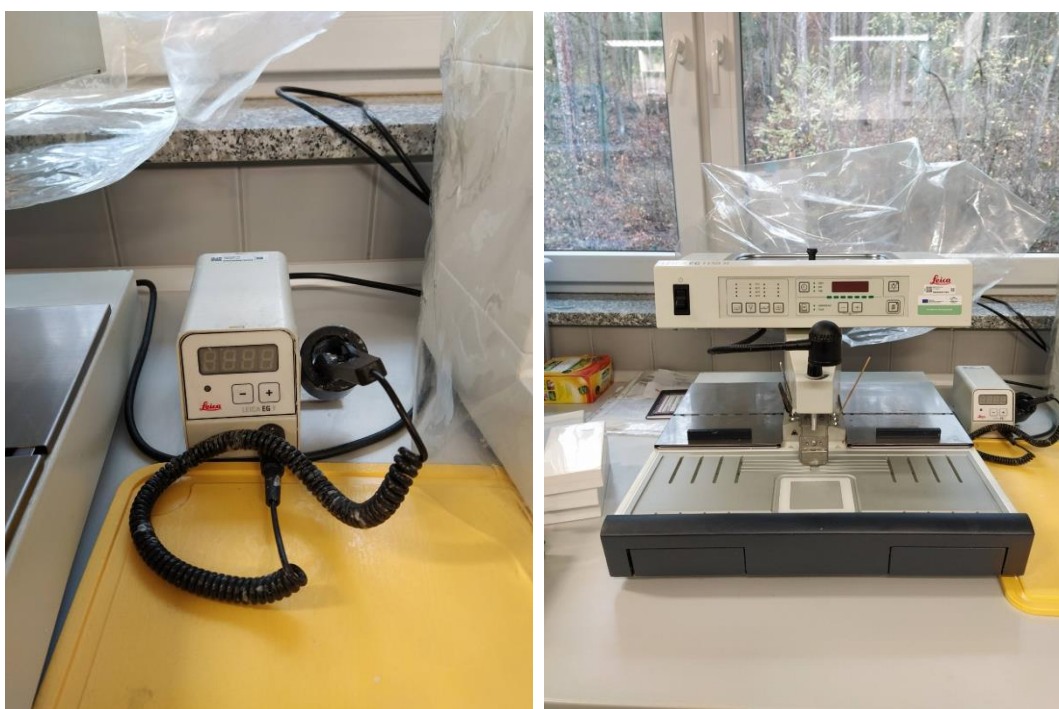
Obrázek 14- vlevo: nahříváná pinzeta pro manipulaci se vzorkem při zalévání do bločků; vpravo: termostat určený k zalévání do bločků roztaveným parafínem (foto: V. Kučera).
