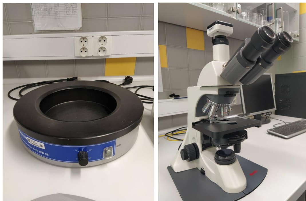
Obrázek 15- Vlevo: vodní lázeň určená pro montování slidů na podložní sklička; vpravo: optický mikroskop s kamerovým systémem Olympus E-600 pro vyšetřování hotových preparátů (foto: V. Kučera).
