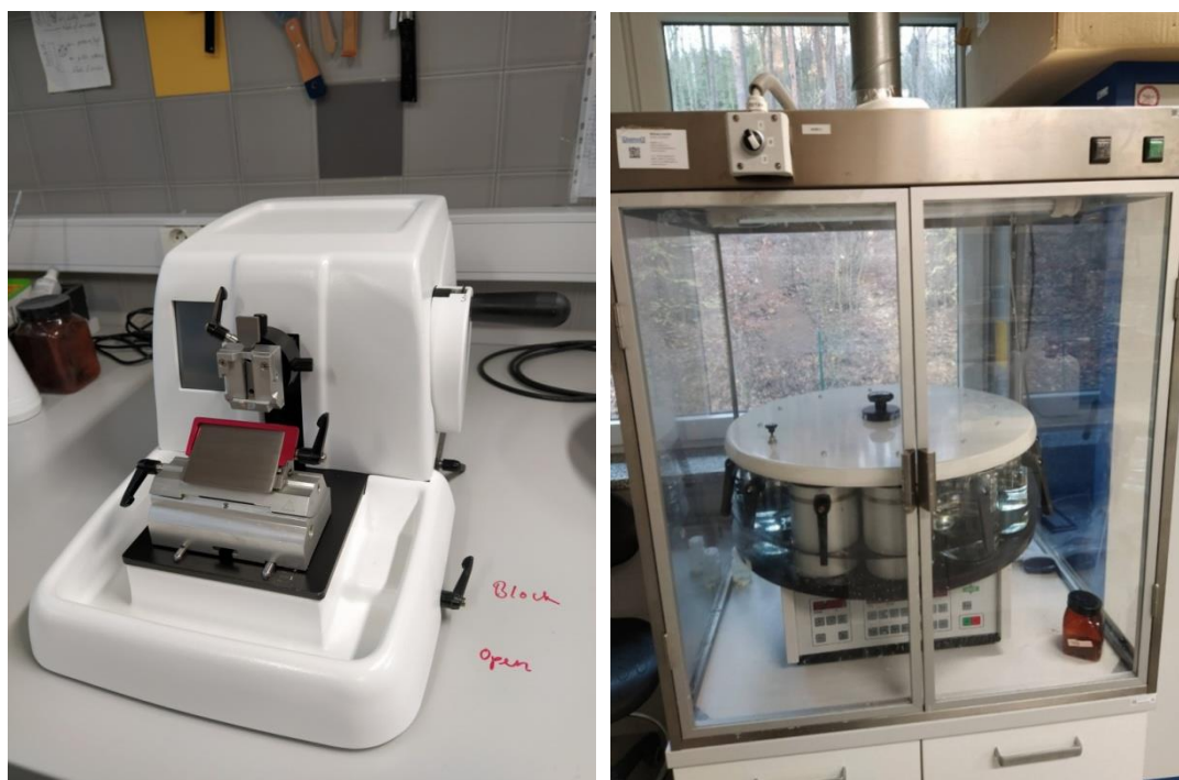
Obrázek 12- vlevo: rotační mikroskop používaný v Laboratoři vodní toxikologie a ichtyopatologie ve Vodňanech na Fakultě rybářství a ochrany vod.; vpravo: tkáňový procesor Histomaster 2052/1,5 (MDS-group, Germany) používaný k odvodnění v řadě koncentrací etanolu, aplikaci xylenu a následnému prosycení parafínem (foto: V. Kučera).
