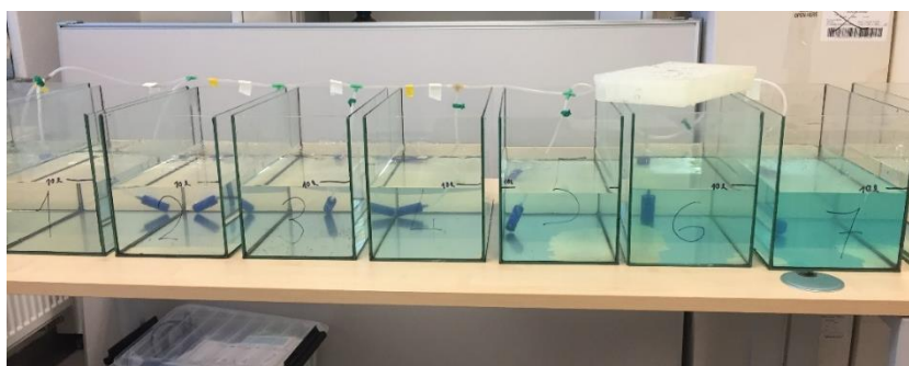
Obrázek č. 6. Koncentrační řada při akutním testu toxicity s neonikotinoidovým přípravkem (Foto: A. Strouhová).
