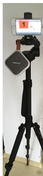
Obr. 3-2 Snižování odrazu zvuku v učebně metodou prostorové akustiky a upevnění zdroje stálého zvuku na stativ. Gymnázium Trhové Sviny, dne 21.6.2018
