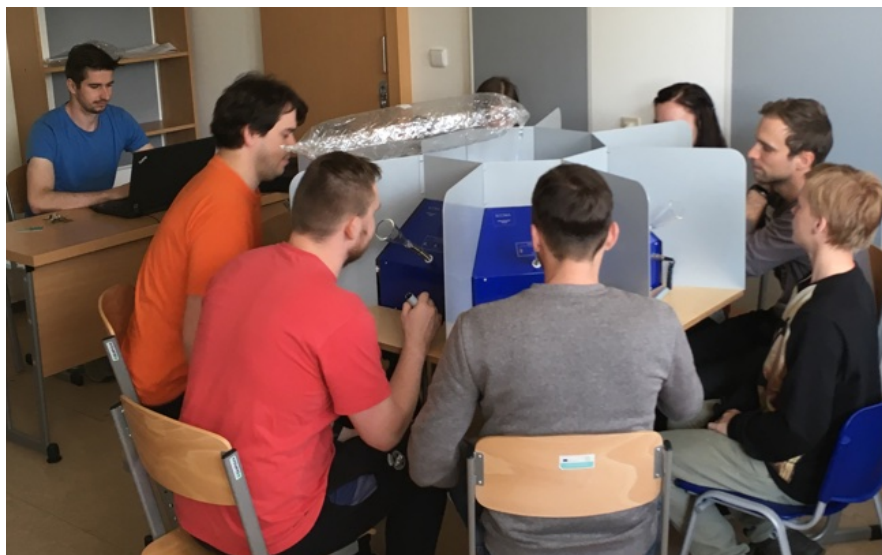
Obr. 5-4 Osm respondentů analyzujících pachy na olfaktometru T-08, ZF JČU, České Budějovice, dne 17.4.2018
