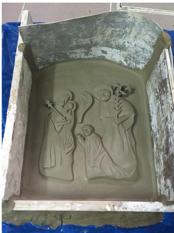
Obr. 33: Příprava sádrové formy
