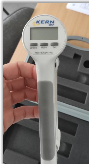
Obrázek 25. Konkrétní přístroj použitý při testování síly zápěstí. (archiv autora, 2019)
