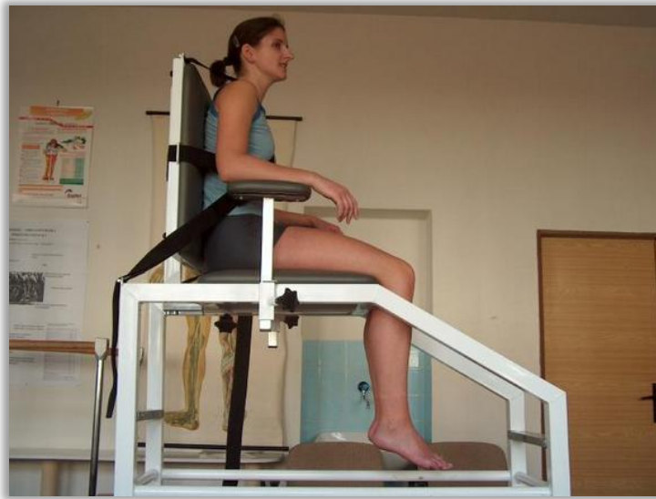
Obrázek 22. Systém pro izometrickou dynamometrii, křeslo pro fixaci testované osoby. (Novotný, 2013, s. 18)
