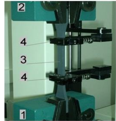
1,2 čelisti zařízení 3 zkušební vzorek 4 průtahoměr
