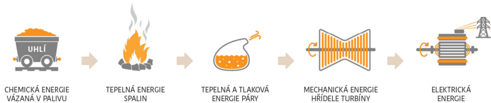
Obrázek č. 1 - Přeměny energií v klasické tepelné elektrárně – převzato z: [20]
