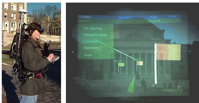
Obrázek 3 Touring Machine (levý). Záznam generovaného obrazu pořízeného na verzi stroje z roku 1999 (pravý).
