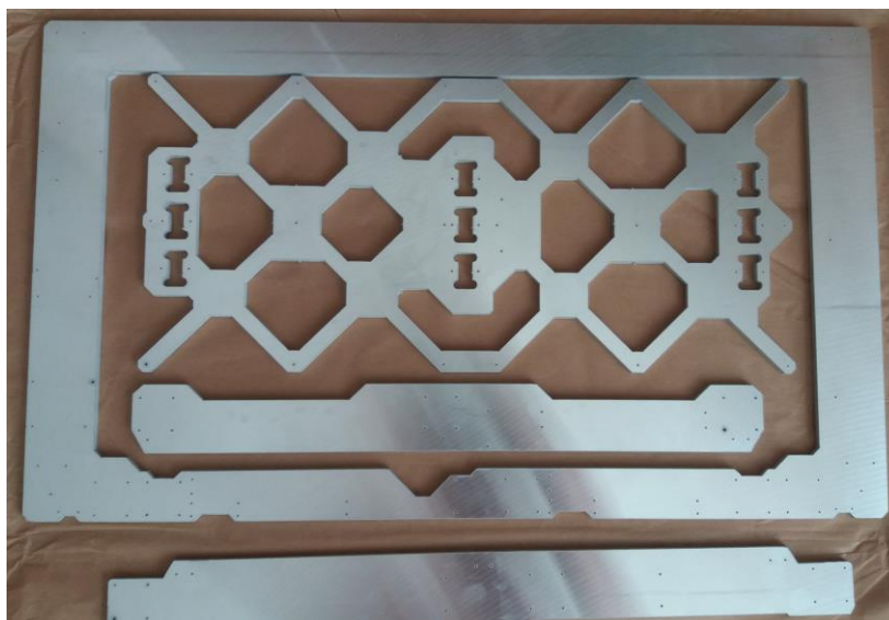
Obrázek 2 - Části rámu tiskárny vyříznuté vodním paprskem 1
