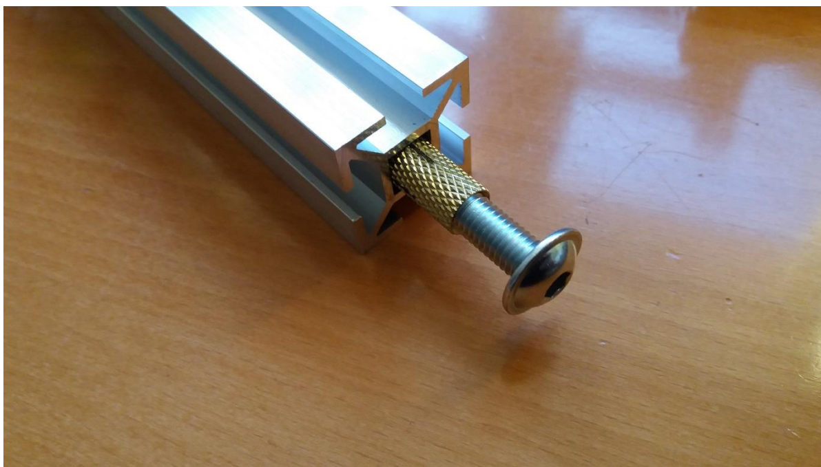
Obrázek 19 - Spojení hliníkových profilů pomocí mosazné hmoždinky
