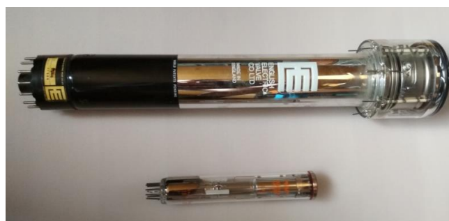
Obrázek 25: Snímací elektronky super ortikon (nahore) a plumbikon (dole) (Zdroj: autor)
