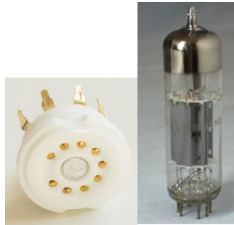
Obrázek 41. Objímka elektronky a elektronka typu noval. (Zdroj: autor)
