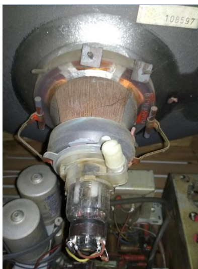
Obrázek 20: Umístění vychylovací jednotky na hrdle černobílé televizní obrazovky. (Zdroj: autor)
