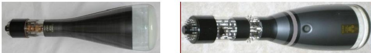
Obrázek 17: Obrazovka s elektrostatickým vychylováním s jedním elektronovým systémem a s dvěma systémy. (Zdroj: [3])
