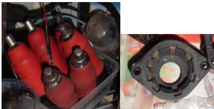
Obrázek 63: Elektronky „rudá série“ Philips a odpovídající objímka. (Zdroj: autor)
