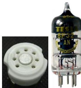
Obrázek 42: Objímka elektronky a elektronka typu heptal. (Zdroj: autor)
