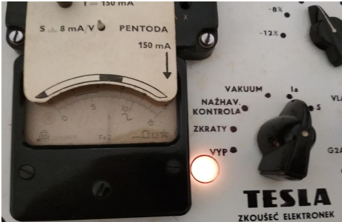
Obrázek 49: Měření anodového proudu. (Zdroj: autor)
