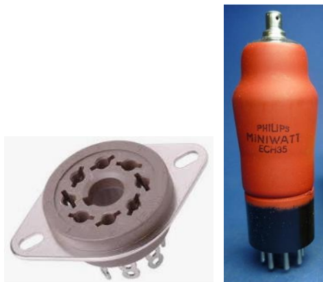
Obrázek 37: Objímka elektronky a elektronka typu octal. (Zdroj: autor)
