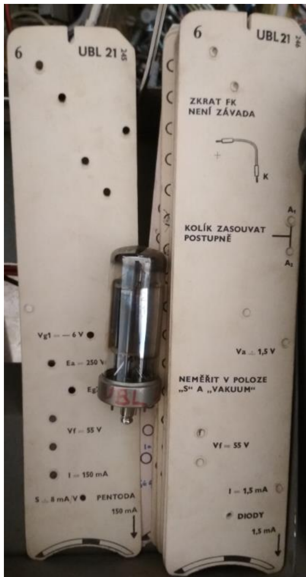
Obrázek 47: Karty k elektronce a elektronka, kterou chceme měřit. (Zdroj: autor)
