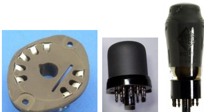
Obrázek 35: Objímka elektronky a elektronka typu T. (Zdroj: autor)
