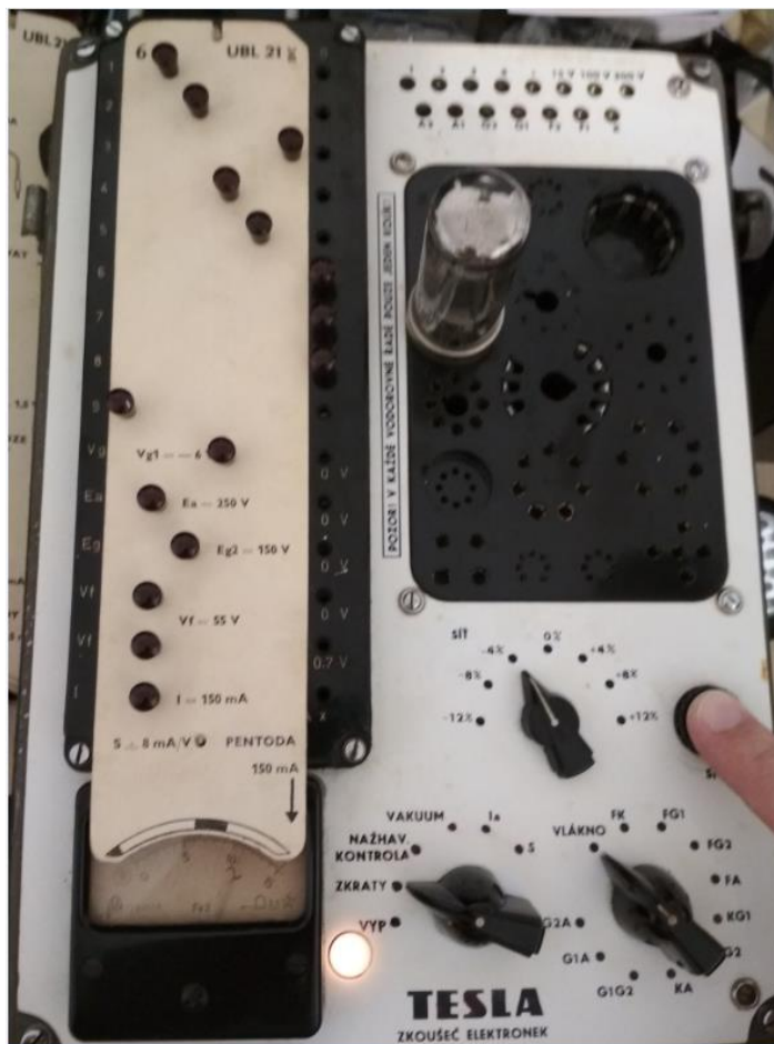
Obrázek 48: Kontrola nastavení odchylky síťového napětí. (Zdroj: autor)
