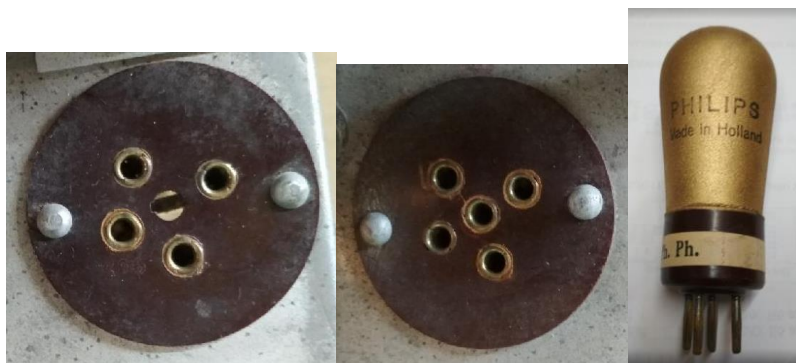
Obrázek 32: Čtyř a pěti kolíková objímka elektronky, kolíková elektronka. (Zdroj: autor)
