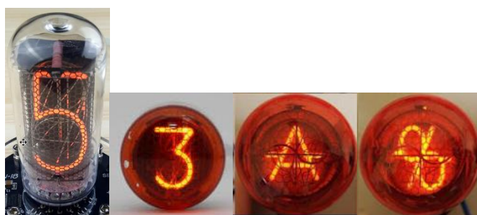
Obrázek 29: Digitrony zobrazující číslice a znaky (Zdroj: autor)
