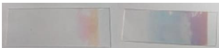
Obrázek 6 Vrstvy (doba depozice 32 s vlevo, 64 s vpravo) po skončení zahřívání na teplotě 500 °C
