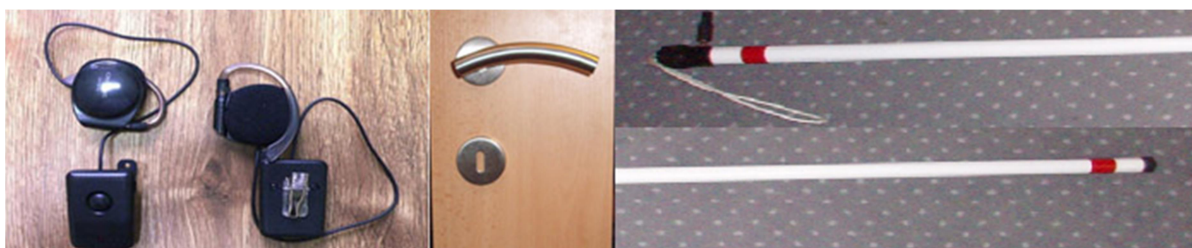
Obrázek 7: Bezdrátové sluchátko, klika se zabudovaným zdrojem informací a detail hole se zabudovaným snímačem magnetů
