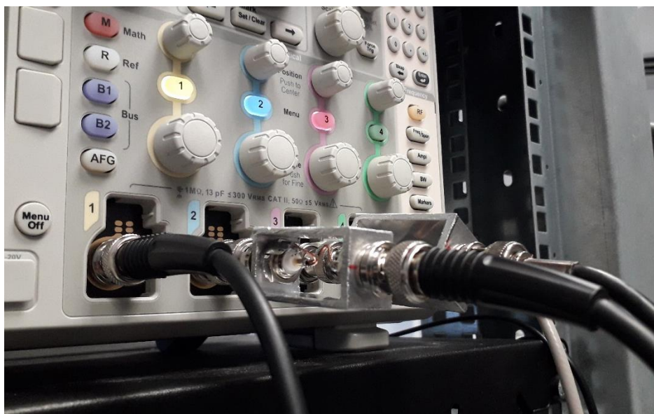
Obrázek 15: Ukázka zapojení krabiček s rezistory pro VF aplikace na druhé straně jumperů.
