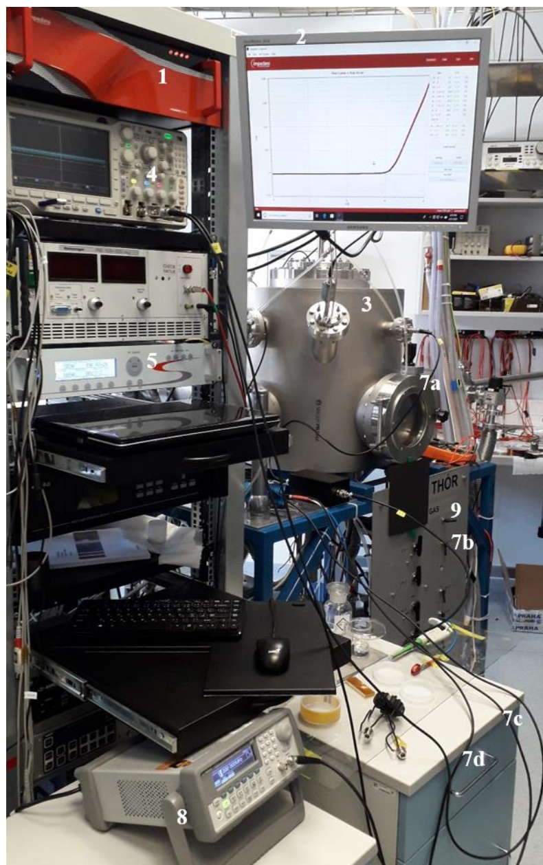
Obrázek 18: Celkový pohled na měřící aparaturu: 1 – Langmuirova sonda, 2 – grafický výstup z Langmuirovy sondy, 3 – vakuová komora, 4 – osciloskop, 5 – zdroj RF napětí pro plazmatický výboj, 6 – Rogowského cívka, 7 (a,b,c,d) – měřící kabely, 8 – zdroj RF napětí pro měření signálu na Rogowského cívce, 9 – ventil plynu.
