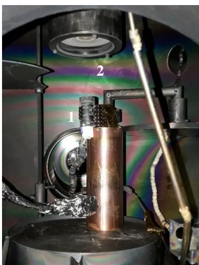
Obrázek 16: Umístění Sobolewského sondy (1) pod magnetronem (2) ve vakuové komoře.
