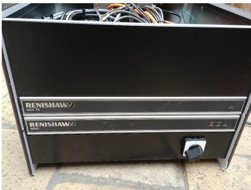
Obrázek 38 – Umístění UCC T5 a SPA3 do předem připraveného boxu
