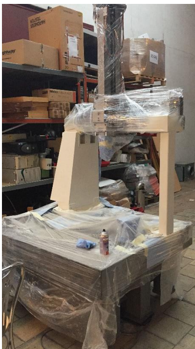
Obrázek 23 – Příprava stroje na ruční lakování
