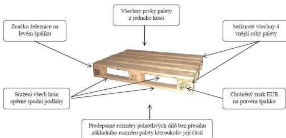
Obrázek 6: Euro-paleta specifikace
