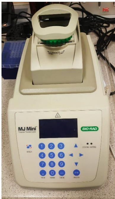
Obrázek 26 Termocycler MJ Mini od výrobce Bio-Rad (zdroj: vlastní)
