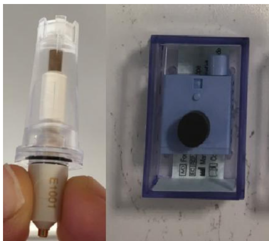
Obrázek 9. Argentchloridová elektroda na analyzátoru acidobazické rovnováhy a krevních plynů ABL835 Flex firmy Radiometer a na analyzátoru Cobas 8000 firmy Roche (zdroj: vlastní)
