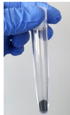
Obrázek 34: Zkumavka s aktivním uhlím (stanovení oxalátů metodou firmy LTA) Zdroj: vlastní foto
