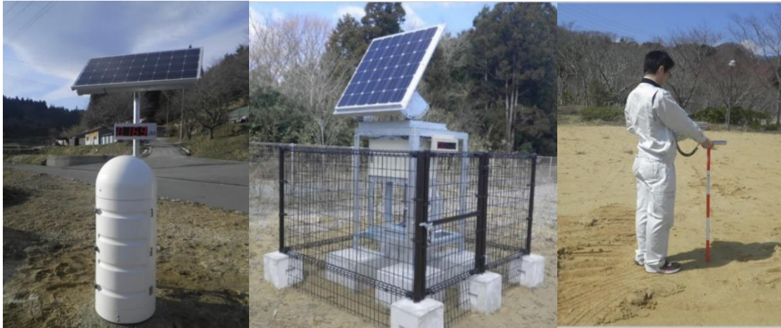
Obrázek 14 Stacionární měřící systém, přenosné monitorovací stanoviště a pěší průzkumník (zdroj: Fukushima Prefecture, 2020)
