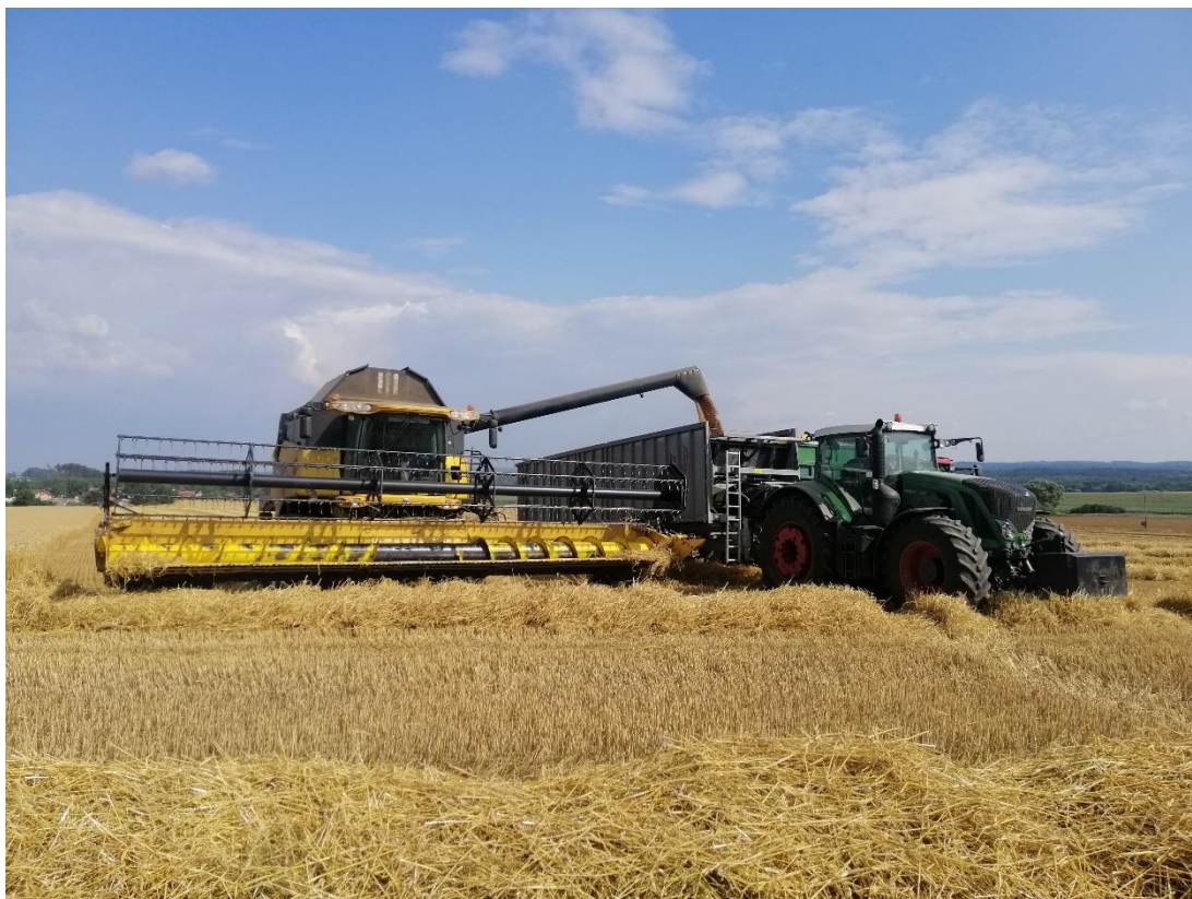
Obrázek 8 - Vyprázdnění zásobníku do odvozové soupravy (archiv autora)
