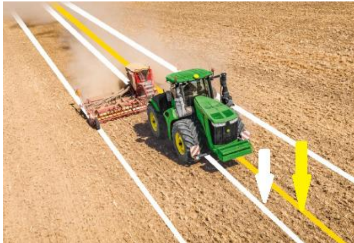
Obrázek 1. 7: Vyrovnání bočního posuvu; žlutá šipka –stopa traktoru, bílá šipka –stopa nářadí (STROM, 2019)
