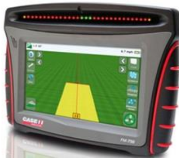
Obrázek 1. 10: Světelná lišta s LCD displejem FM–750 Trimble ( https://www.agrics.cz/fm-750,,20191205 )
