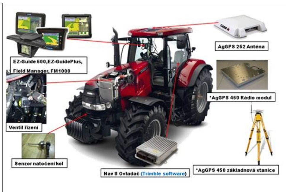
Obrázek 1. 12: Automatizované návádění Case IH ( https://www.agrics.cz/autopilot,,20191216 )
