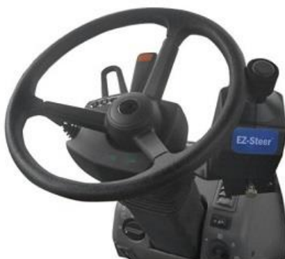
Obrázek 1. 11: Asistované řízení s třecím pastorkem ( https://www.bvtechnika.cz/systemy-asistovaneho-rizeni,,20191205 )
