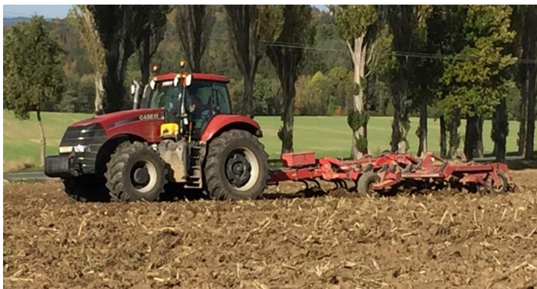
Obrázek 22 - Hlubkové kypření soupravou Case magnum 290 + Tiger 4 AS
