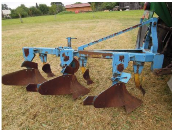
Obrázek 9 - Pluh s předradličkou [34]
