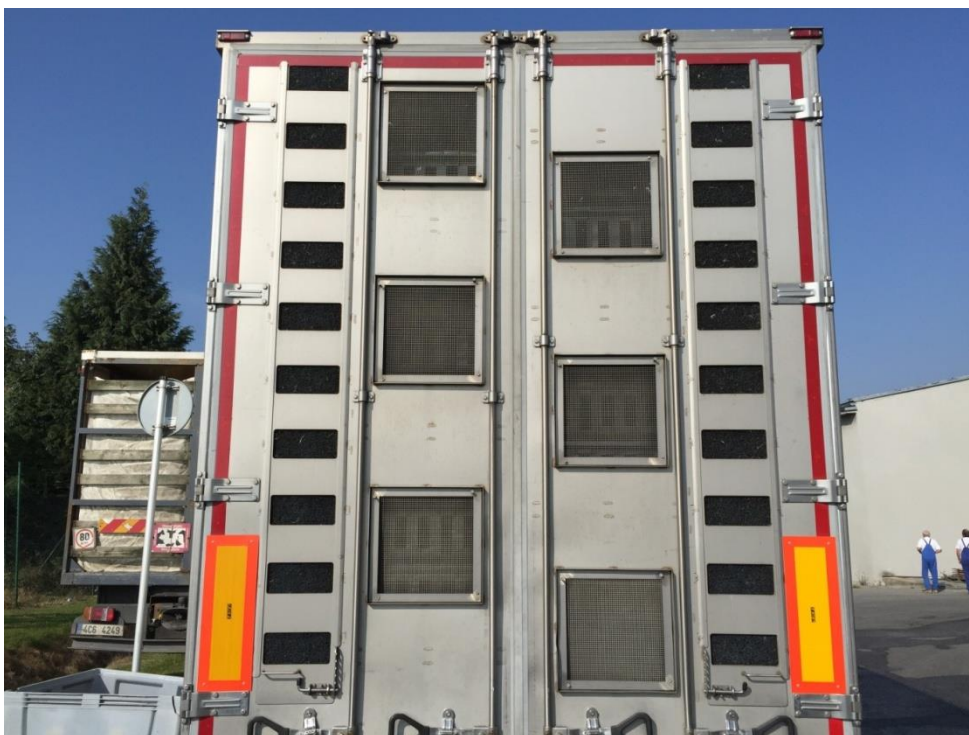
Obrázek 18: zadní část návěsu bez ventilátorů (letní režim)
