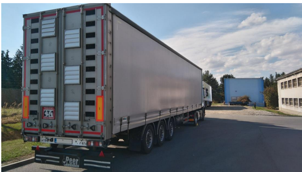
Obrázek 17: ventilátory na zadní části (zimní režim – žaluzie na ventilaci)
