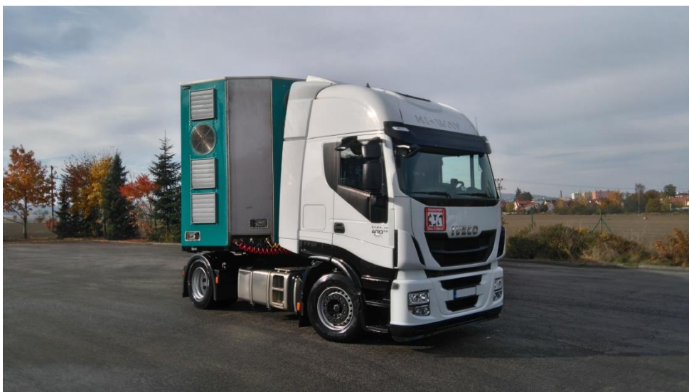
Obrázek 16: ventilátory na přední části návěsu
