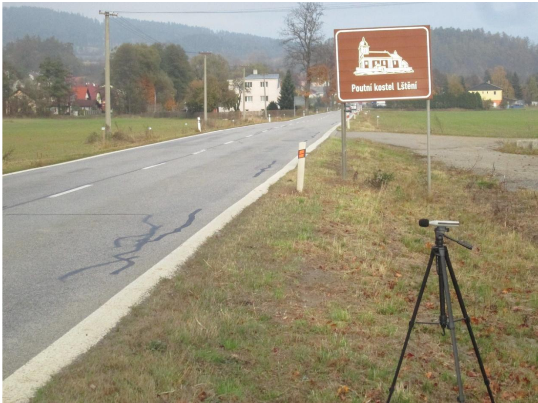
Obrázek 20 – Umístění hlukoměru VOLTcraft SL – 100 (Zdroj: „Pavel Kůrka“)
