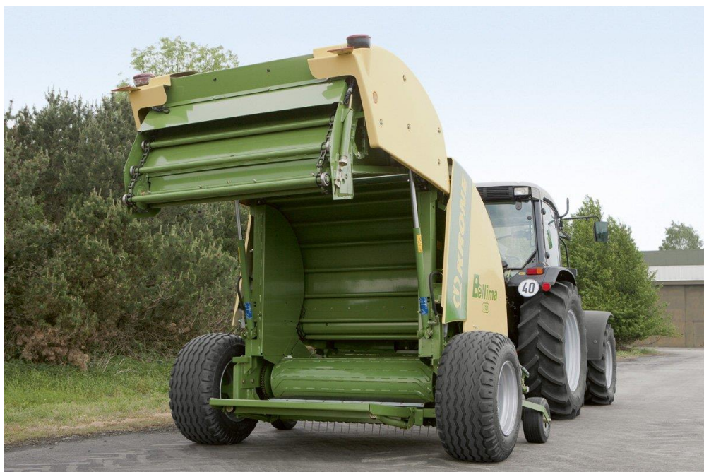
Obrázek 11 Svinovací lis s příčkovým řetězovým dopravníkem [16]
