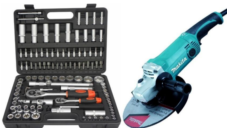
Obr. 25: Důležité dílenské vybavení k demontáži autovraku (sada gola klíčů, kotoučová úhlová bruska)
