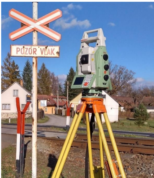
Obrázek 19 - Robotická totální stanice Leica Nova MultiStation (MS50) s barevným displejem (Zdroj: vlastní).
