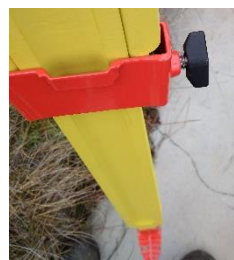
Obrázek 27 Šroub k utažení nohou (Zdroj: vlastní).
