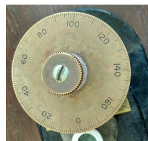
Obrázek 58 - Odečítací kruh rektifikačního pravítka (Zdroj: vlastní).
