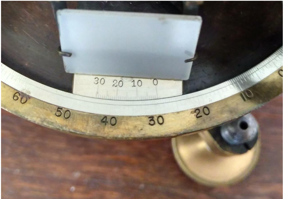
Obrázek 65 - Detail vernieru (Zdroj: vlastní).
