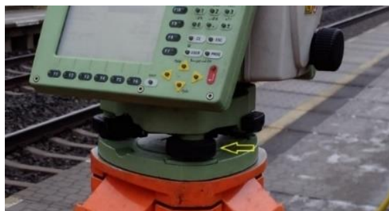
Obrázek 26 - Stavěcí šrouby na podložce u dnešních přístrojů (Zdroj: vlastní).
