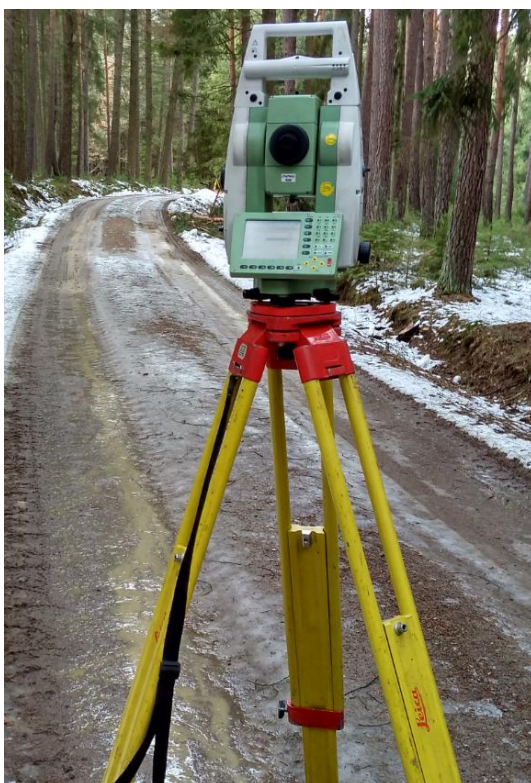
Obrázek 21 - Starší verze totální stanice Leica 1200, černobílý displej (Zdroj: vlastní).
