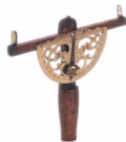
Obrázek 2 - Průzor pro měření svislých úhlů (Zdroj: Hánek, 2000).
