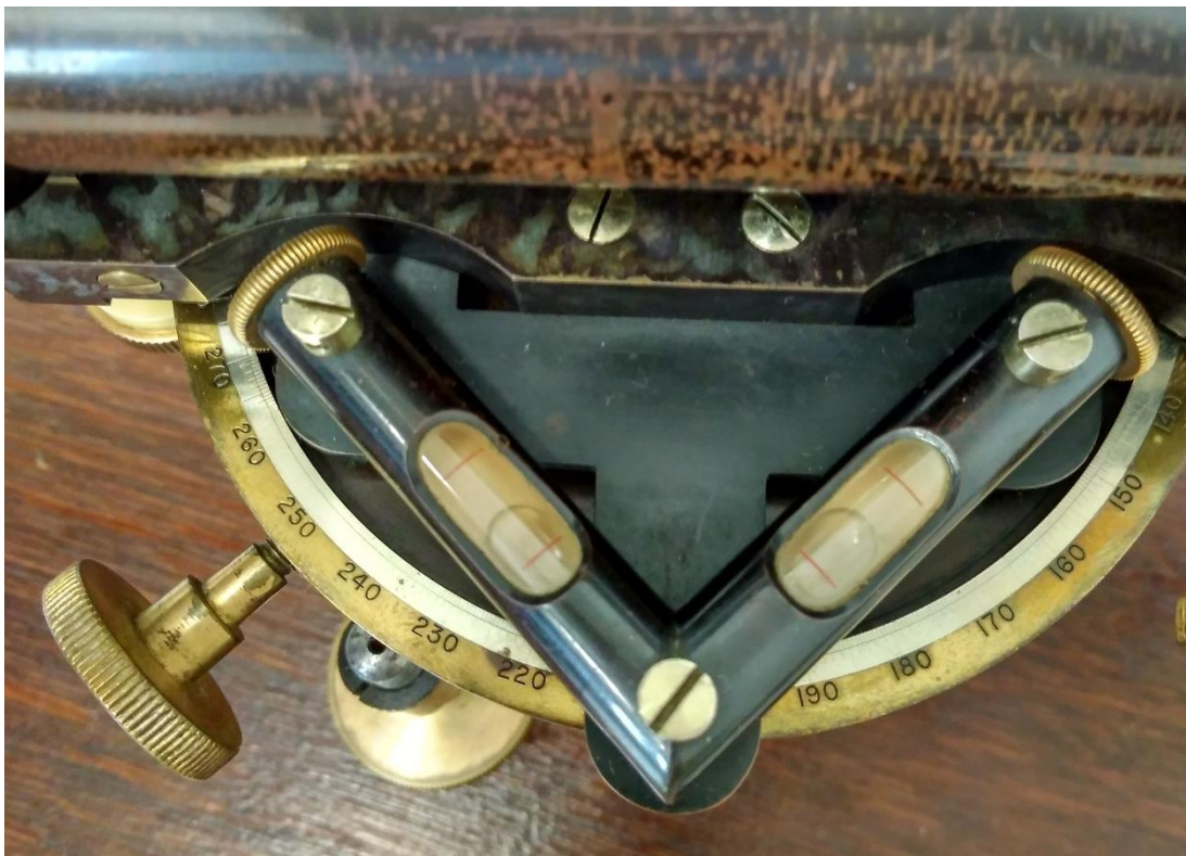
Obrázek 64 - Detail křížové libely (Zdroj: vlastní).
