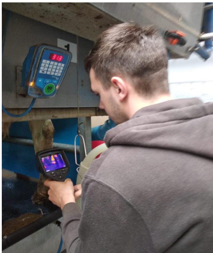
Obrázek 10: Měření termokamerou v dojírně
