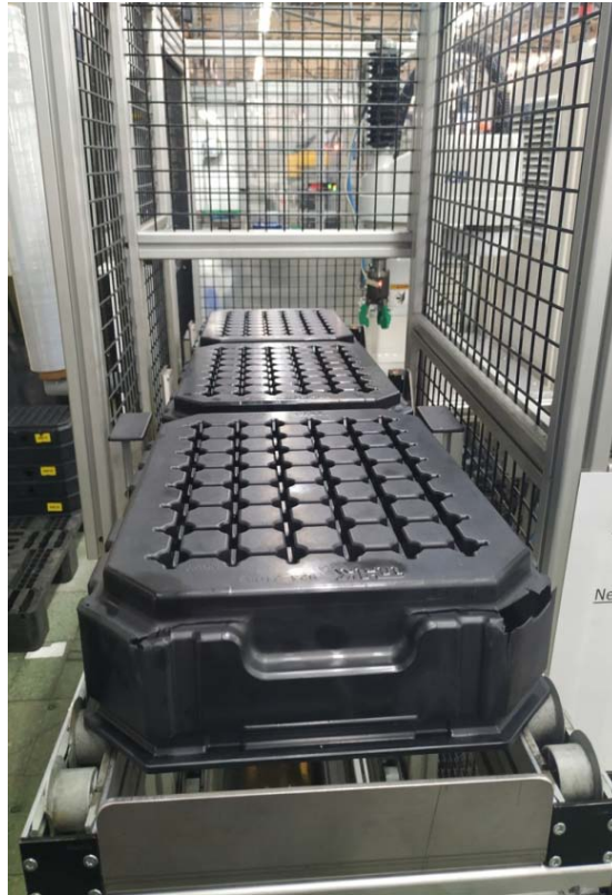
Obrázek 12 Vkládání prázdných paletků do stroje
