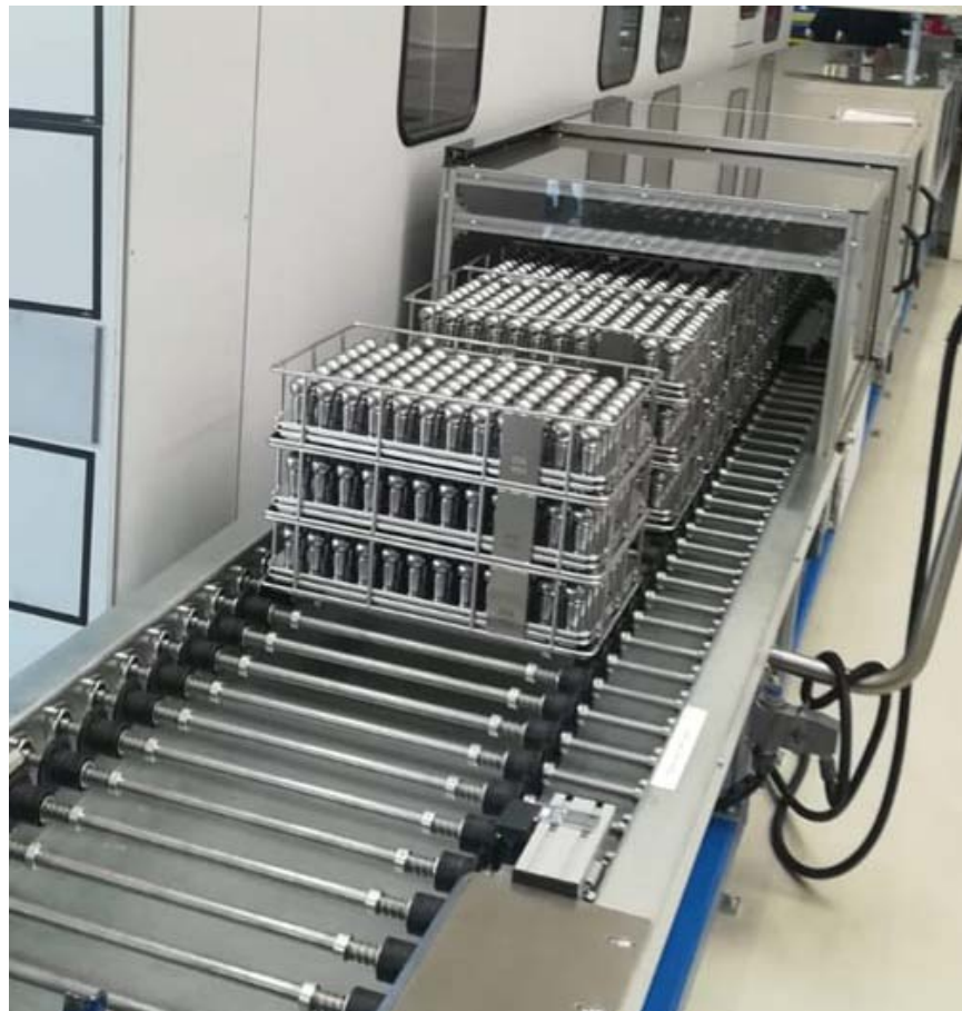
Obrázek 27 Palety s čepy ve vibrační pračce
