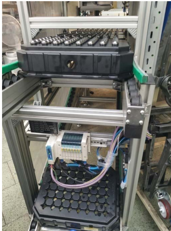
Obrázek 13 Vkládání plných paletků do stroje
