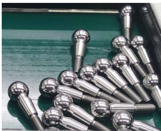
Obrázek 6 Kulové čepy ve výrobním procesu
